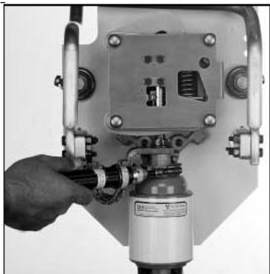
Рис. 24. Развинтите хомут на верхней части вакуумной камеры
