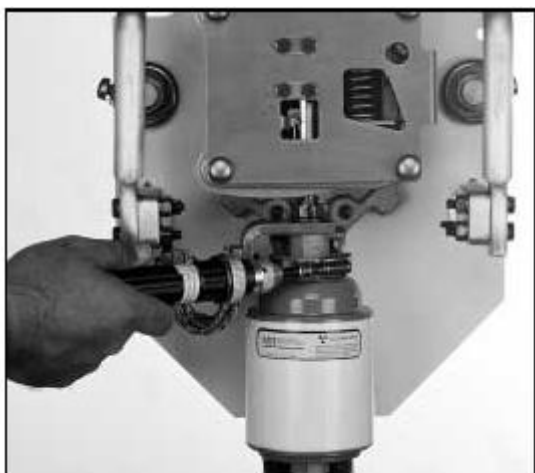
Рис. 30. Установите на место хомут. Не затягивайте хомут слишком сильно.
