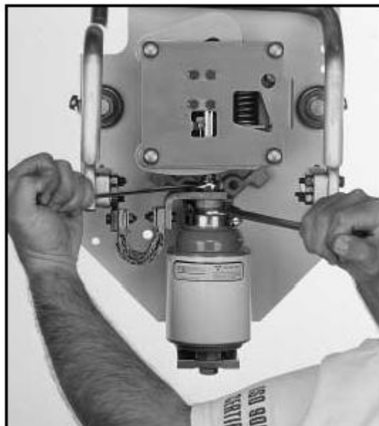
Рис. 22. Удерживая основание подвижного контакта, ослабьте шестигранную контргайку на тяге подвижного контакта
