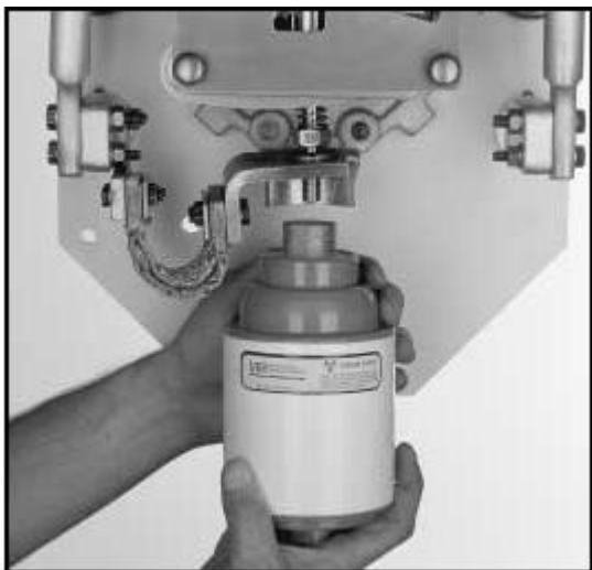
Рис. 28. Навинчивайте рукой до контргайки
