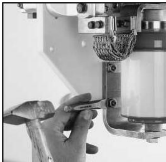
Рис. 29. Головки болтов и гаек должны быть выровнены для удобства стопорения
