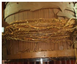
Обмотка с деформированным отводом
