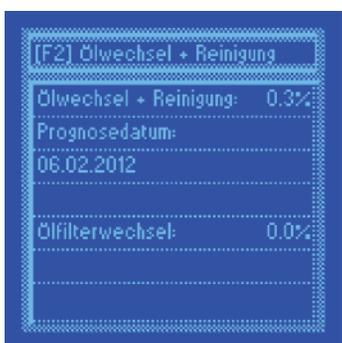
Прогнозируемая дата следующих работ по техническому обслуживанию в соответствии с техническим состоянием устройства РПН
