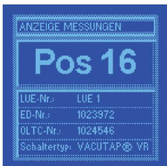
Отображение в главном окне системы мониторинга наиболее важных данных, серийных номеров, положения и типа устройства РПН
